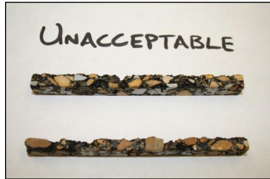
(d) Example of an Unacceptable Beam
